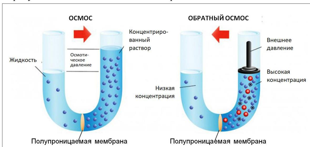
**Вопрос:** Объясните, почему в системах для очистки воды на основе обратного осмоса необходима установка насоса для перекачивания воды.
