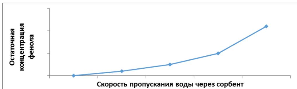
**Вопрос:** Используя данные, представленные на графике, объясните, почему при использовании проточного фильтра не следует превышать скорость фильтрования, указанную производителем.
